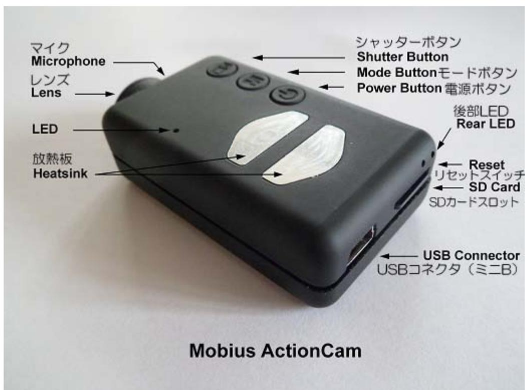
(訳注: Power Button=電源ボタン、Mode Button=モードボタン、Shutter Button=シャッターボタン、Heatsink=ヒートシンク: 放熱板、LED=状態指示用の3色LED、Rear LED=後部の補助的な表示の赤色LED、Reset=奥にリセット用のプッシュスイッチ、Microphone=マイクの位置、Lens=レンズ; この図の Lens A のほかに広角用の Lens B がある、SD Card=マイクロ SD カード用スロット: 金色の端子を上にして先にカチッとほぼ、つらいになるまで差し込む、USB Connector=USB ミニ B オスコネクタ: 標準的なケーブル以外の**特殊なケーブルは、本文の説明をよく読んで適合しないものは使わないでください。カメラを回復不能に壊すことがあります**)
